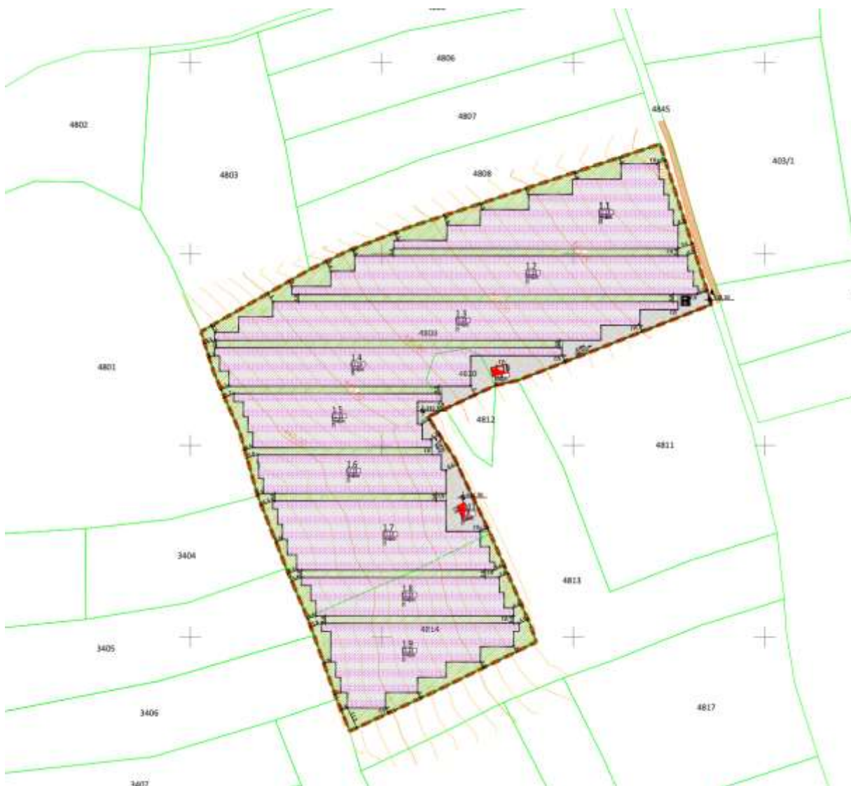
Слика 2. Градежен опфат на фотонапонската централа
